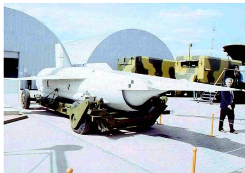
Гиперзвуковой экспериментальный летательный аппарат ГЭЛА на экспозиции авиасалона МАКС. Еще в 1990-е годы он начинал строиться на ДМЗ и стал по существу первым в мире крылатым гиперзвуковым ЛА
