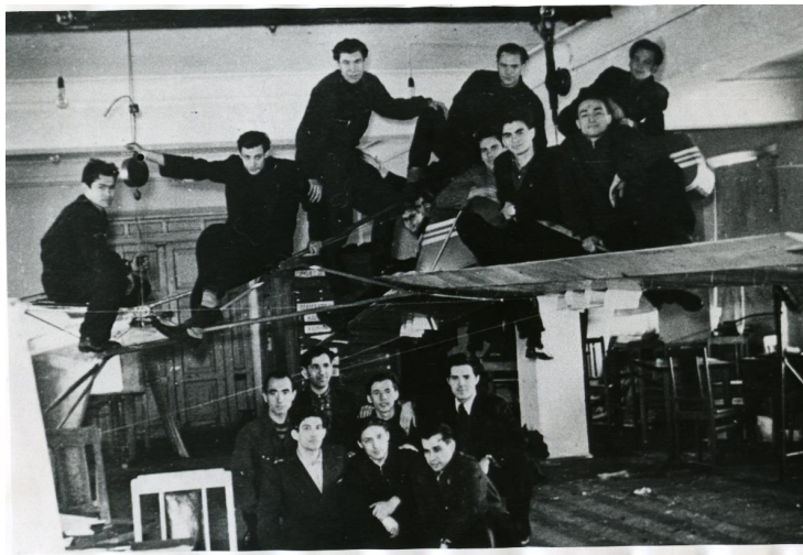
Статические испытания планера КАИ-11 в фойе учебного здания №3. Симонов, как и подобает главному конструктору, находится непосредственно под объектом испытания
