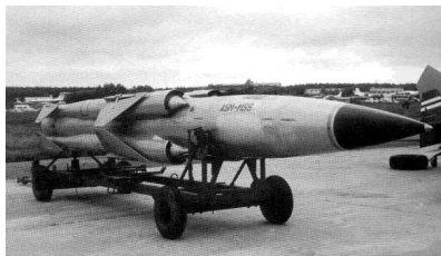
Ракета ЗМ80 «Москит», оснащенная РДТТ и ПВРД
