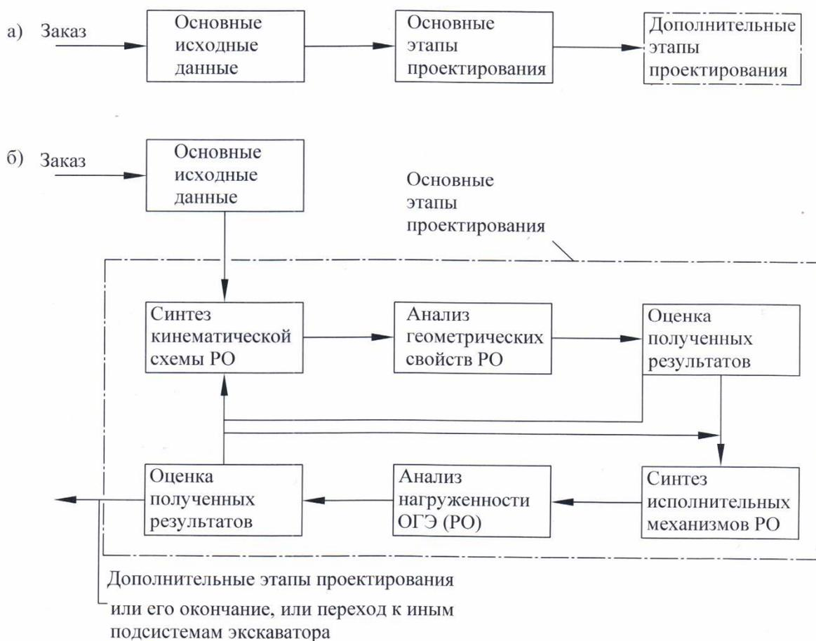
Рис. 2 Схема проектирования РО на стадии ПА
