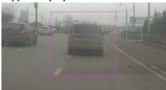
Рис. 2. Результат ошибочного детектирования автомобиля (зеленый прямоугольник)
