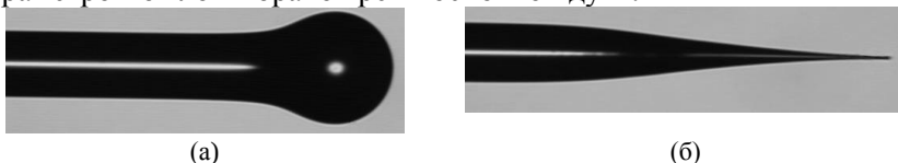
Рис. 1. Пилотные образцы микролинз на торце многомодовых ОВ кат. OM2+
