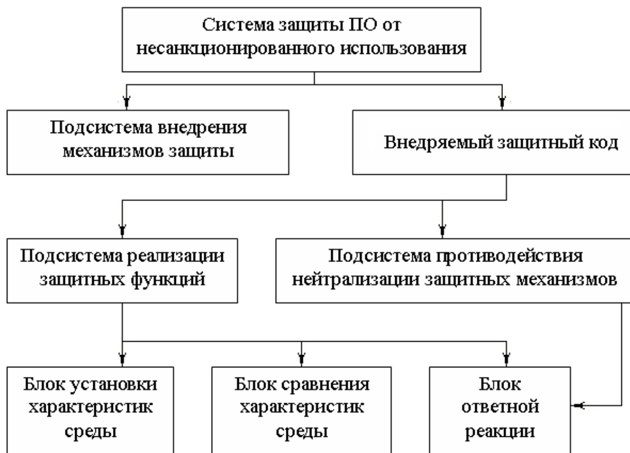
Рисунок 1.1. Модульная архитектура системы защиты программного обеспечения от несанкционированного использования
