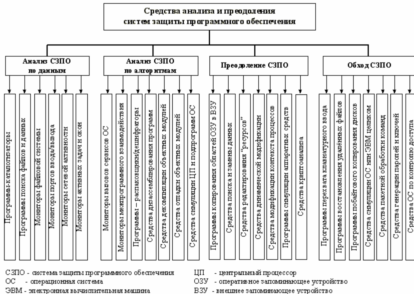
Рисунок 2.2 Средства анализа и преодоления систем защиты программного обеспечения
