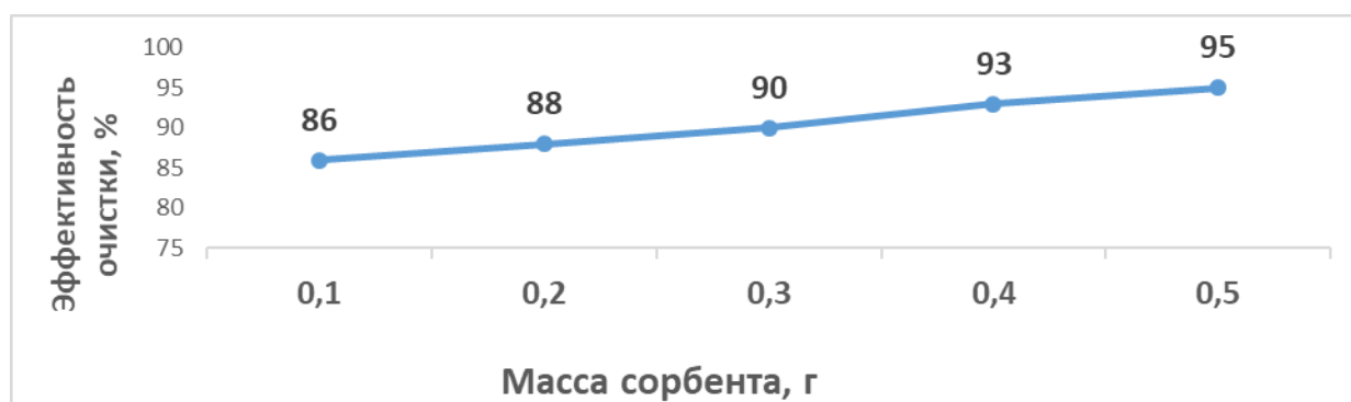
Рис. 2. Зависимость эффективности извлечения эозина от массы сорбента
