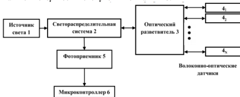
Рис. 1 – Структурная схема многосенсорной системы контроля износа контактной поверхности токоприемников на АВБС.
