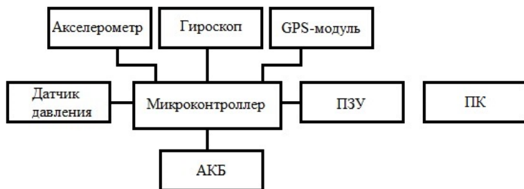
Рис.1 – Структурная схема устройства измерения параметров движения лыжника по трассе.
