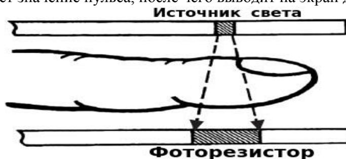
Рисунок 1 – Принцип работы пульсометра
