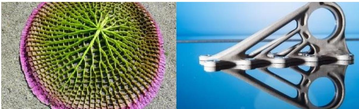
Рисунок 1 – Водяная лилия и деталь, разработанная на ее основе
