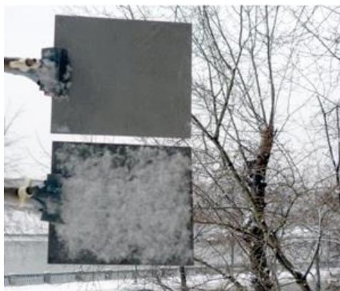
Рисунок 4 – Поверхность с гидрофобным покрытием (сверху) и без покрытия(снизу).
