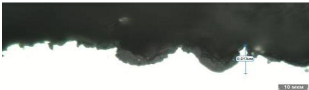
Рисунок 1 - Заштампованная окалина на поверхности детали, \times 1000
