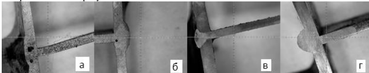
Рисунок 1 - Давление защитного газа а-4 бар, б-2 бар, в-1 бар, г-0,5 бар.
