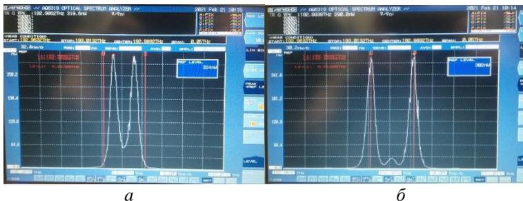
Рис. 3. Варианты кодирования состояний фотонов  $|-\rangle$ ;  $|1\rangle$  (а) и  $|+\rangle$ ;  $|2\rangle$  (б)
