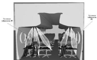
Рис. 7 – Модель освещения посадочных мест в салоне Sukhoi Superjet 100.
