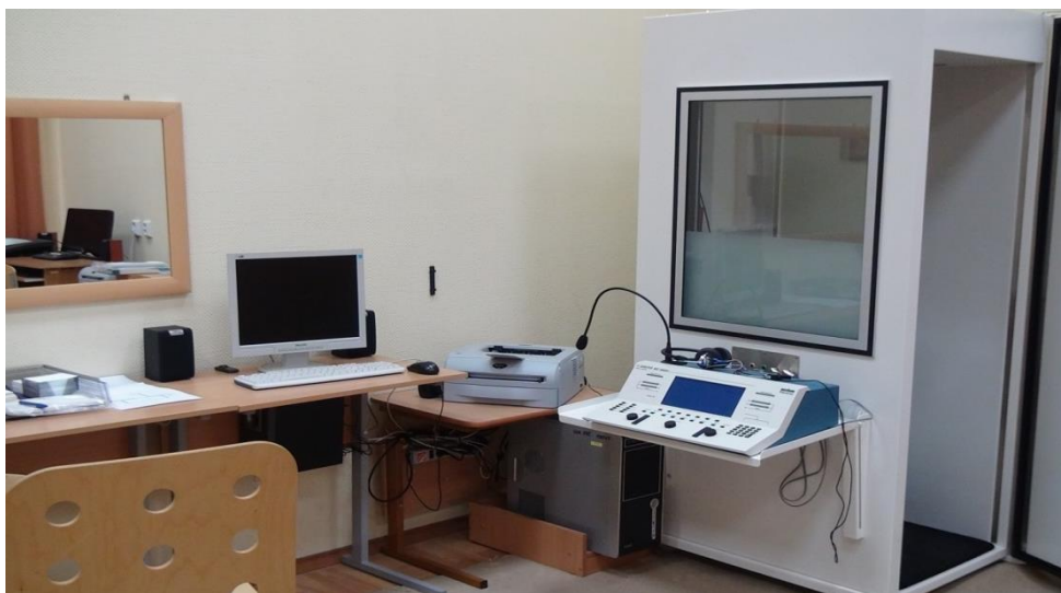
Рис.2.2. Система измерений с заглушенной кабиной
