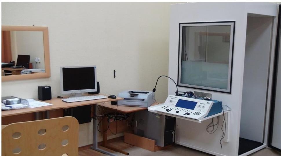
Рис.5.2. Система измерений с заглушенной кабиной
